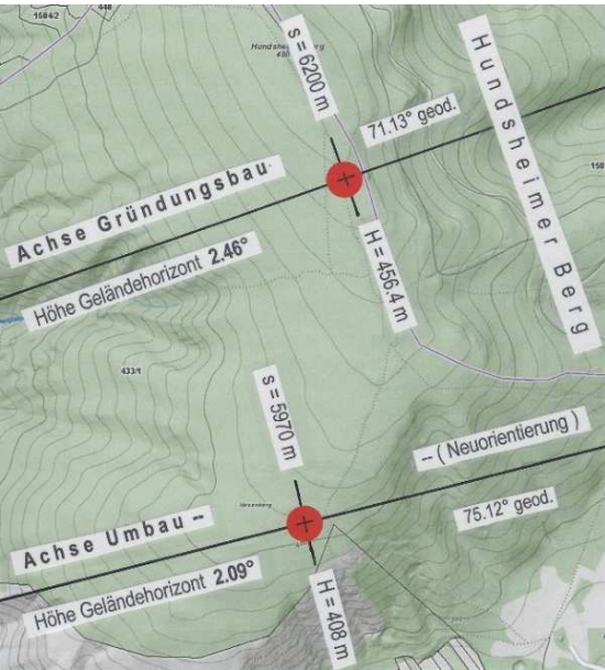
Abb. 81 Rundkirche Petronell, Bestimmung von Lage und Seehöhe der Horizontpunkte in den Achsen des Gründungs- und Umbaus als Grundlage für die Berechnung der jeweiligen Höhe des Geländehorizonts (Tabelle 11)
