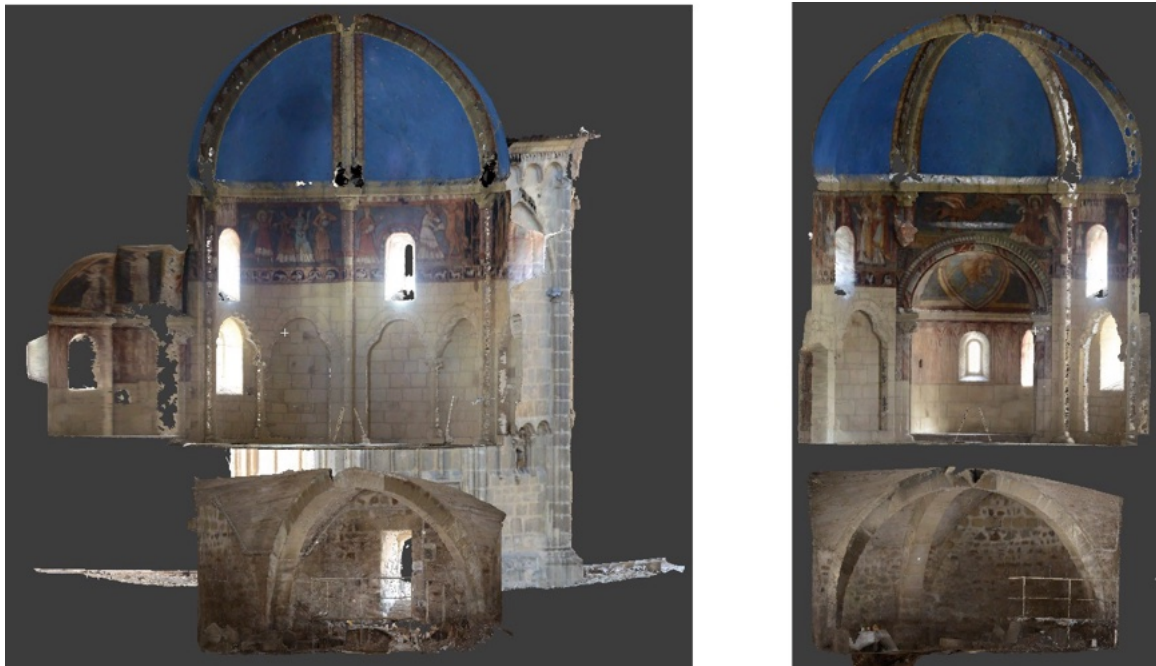
Abb.13: Tullner Karner, Laser Scan, Schnitte in Längsachse und senkrecht darauf (Blick in die Apsis)
